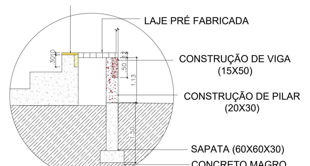
DETALHE CORTE DEMOLIÇÃO/CONSTRUÇÃO
